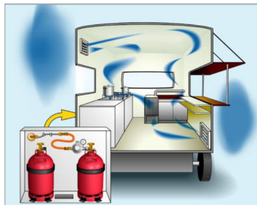
Abbildung 3: Aufstellung der Flüssiggasflaschen im Flaschenkasten des Fahrzeugs
